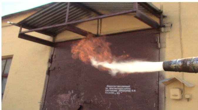
Рис. 3 Факел горения генераторного газа
