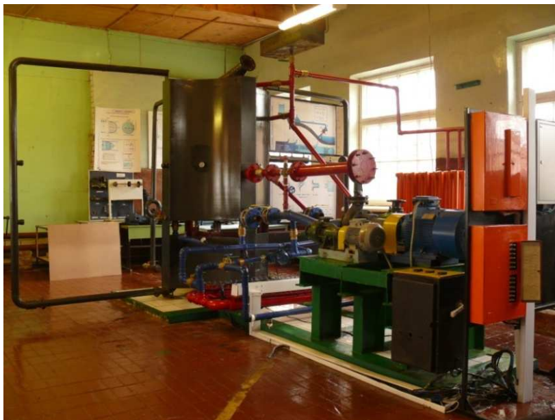
Рис.1. Стенд для испытаний электрических подогревателей воды
