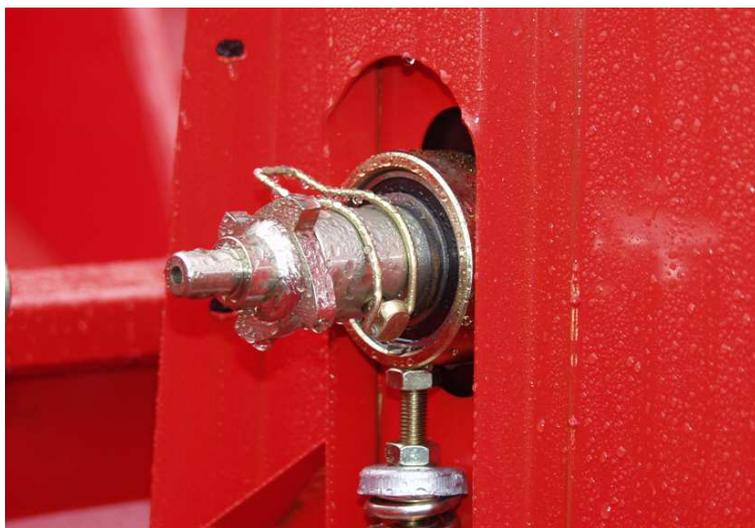
Рис. 7. Выключатель отдельных высаживающих аппаратов
