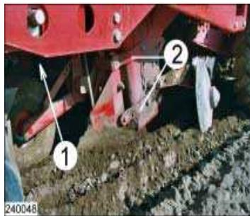
Рис. 3. Точная регулировка положения параллелограммной подвески:
