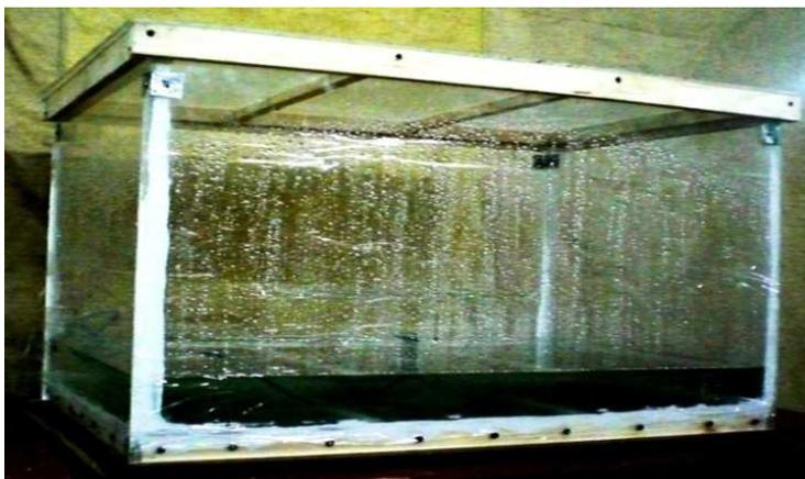
Рис. 1. Гигростат собственной конструкции (согласно ГОСТ 9054 – 75 п. 3.5)
