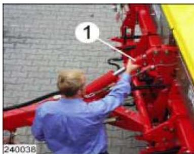
Рис. 2. Регулировка положения длины гидроцилиндра дышла: 1 – упорное кольцо
