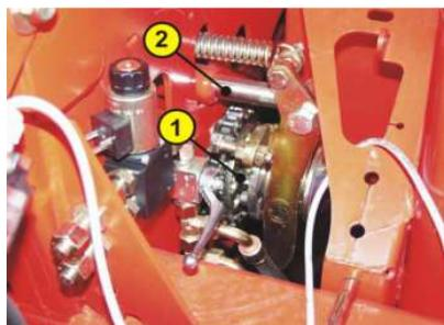
Рис. 6. Муфта отключения высаживающих аппаратов: 1 – муфта, 2 – гидроцилиндр
