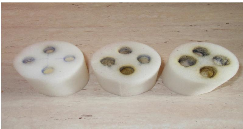
Рис. 3. Чистящие элементы с различным диаметром воздухопроводных каналов
