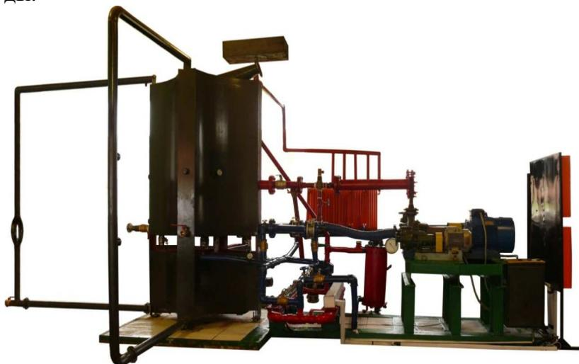
Рис. 1. Лабораторный стенд испытаний подогревателей воды (вид сбоку)
