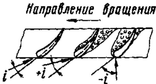
Рис. 7. Поток при различных углах атаки
