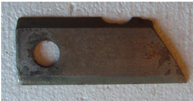
Рис. 2. Результат ударного изнашивания ножа косилки
