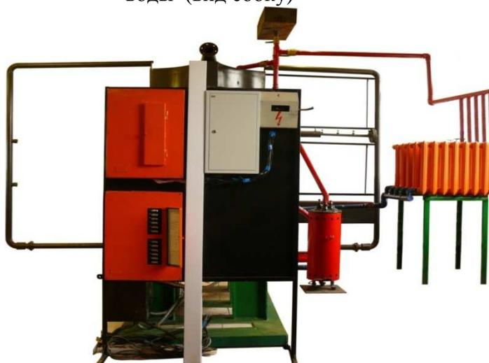
Рис. 2. Лабораторный стенд испытаний подогревателей воды (вид спереди)
