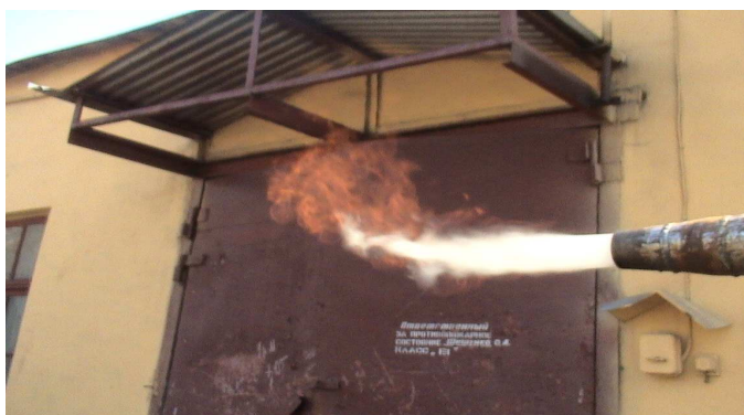
Рис. 3 Факел горения генераторного газа
