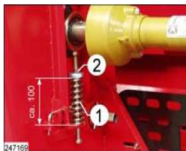
Рис 12. Регулировка натяжного устройства ленты высаживающего аппарата: 1 – пружина, 2 – гайка
