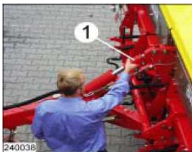
Рис. 2. Регулировка положения длины гидроцилиндра дышла: 1 – упорное кольцо
