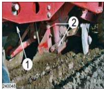
Рис. 3. Точная регулировка положения параллелограммной подвески: 1 – регулировочный винт, 2 – параллелограммный механизм
