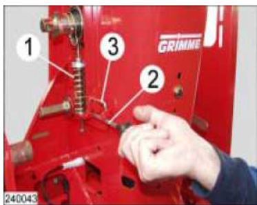
Рис 11. Устройство для быстрого натяжения ленты: 1 – пружина натяжная, 2 – шплинт, 3 – устройство ослабления натяжения
