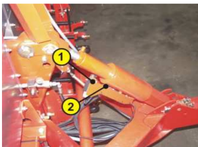
Рис. 5. Регулировка положения датчика отключения высаживающих аппаратов: 1 – датчик, 2 – регулировочные винты
