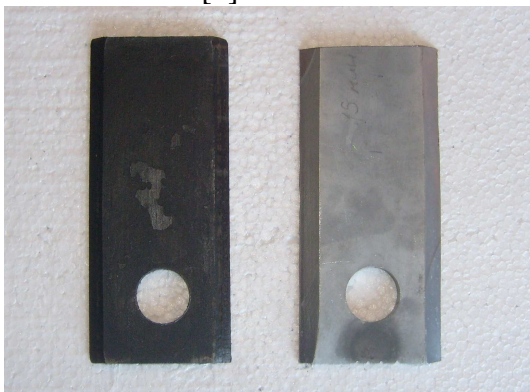
Рис. 1. Стандартный (слева) и хромированный ножи
