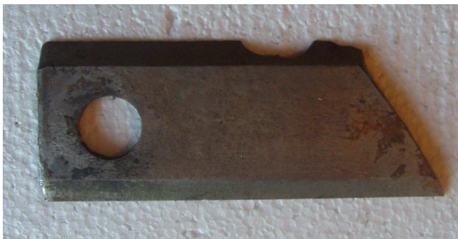
Рис. 2. Результат ударного изнашивания ножа косилки
