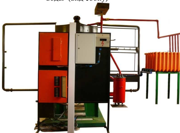
Рис. 2. Лабораторный стенд испытаний подогревателей воды (вид спереди)
