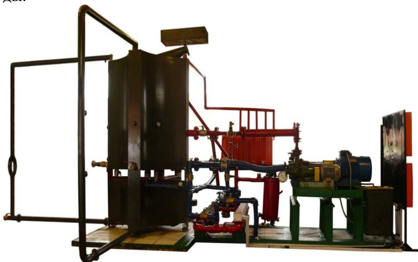
Рис. 1. Лабораторный стенд испытаний подогревателей воды (вид сбоку)
