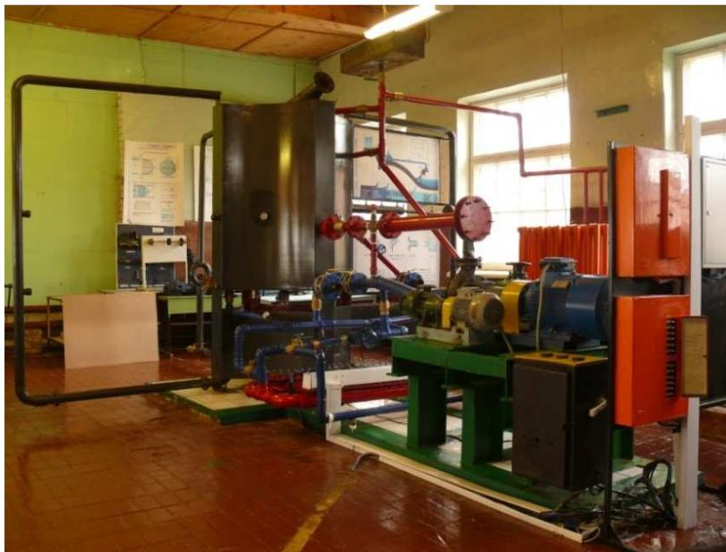
Рис.1. Стенд для испытаний электрических подогревателей воды
