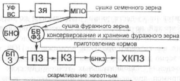
Рис. 2. Схема технологической линии переработки влажного фуражного зерна:
