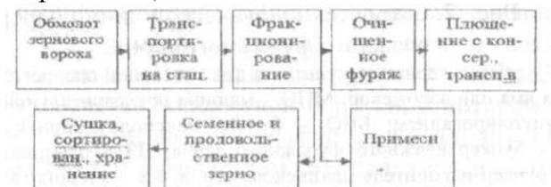
Рис. 1. Технологическая схема производства плющеного фуражного зерна на стационарном пункте (по патенту РФ № 2371262)
