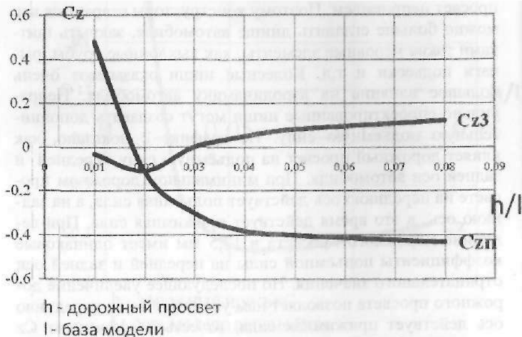
Рис 3. Влияние дорожного просвета на распределение вертикальных нагрузок
