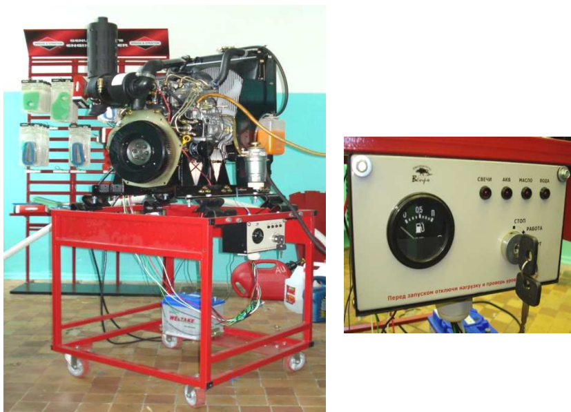
Рис. 1. Дизельный двигатель Vanguard ID 950T и пульт управления зажиганием двигателя
