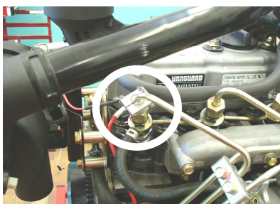
Рис. 5. Датчик момента впрыска топлива и импульсы, отражаемые на ЭВМ
