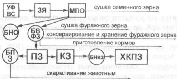
Рис. 2. Схема технологической линии переработки влажного фуражного зерна:
