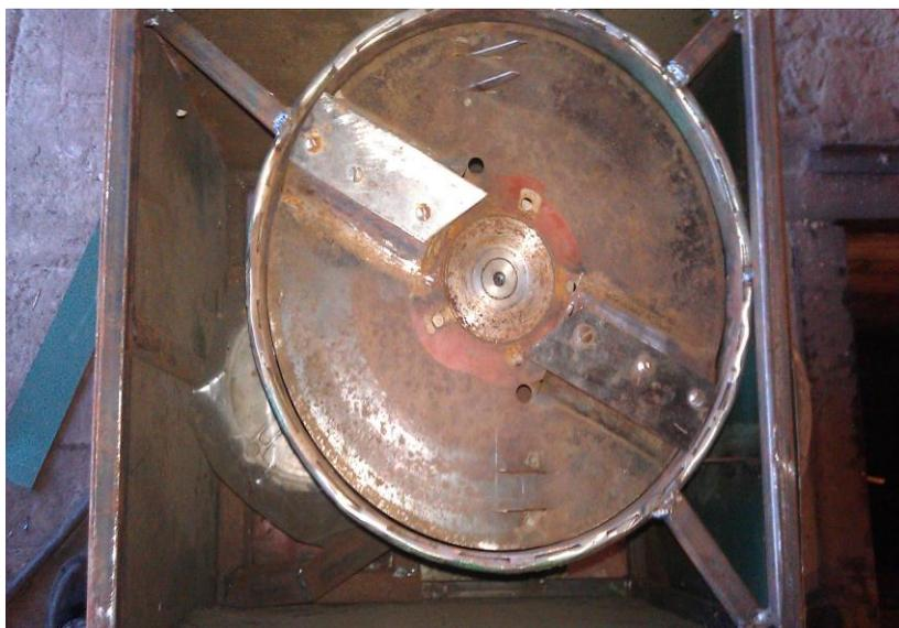
Рисунок 2 – Режущий диск с приводом и система привода, натяжного устройства, выгрузное окно
