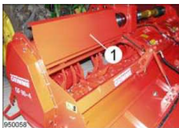
Рис. 7. Доступ к фрезобарабану через щиток: 1) щиток
