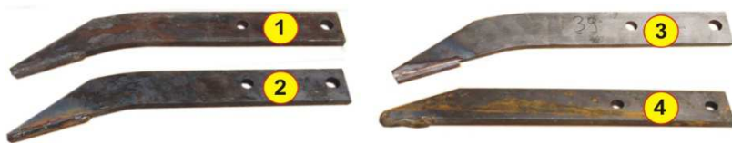
Рис. 4. Рабочие органы (зубья) гребнеобразующих фрез серии GF
