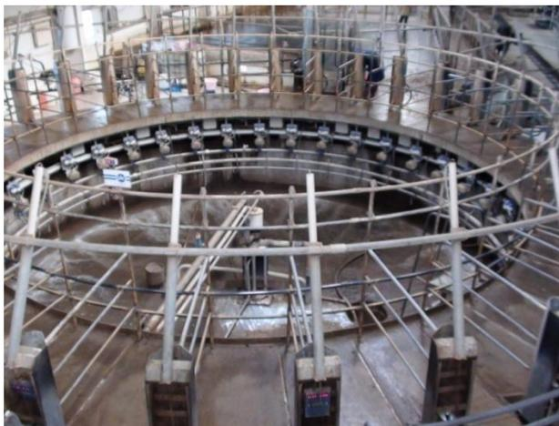
Рисунок 3 – «Карусель» фирмы SAC с 36-ю доильными станками
