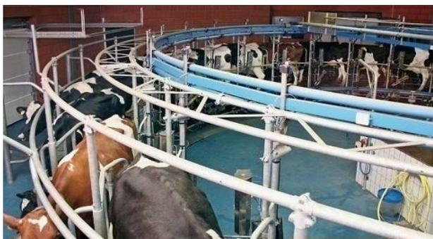
Рисунок 1 – «Карусель» с косым расположением станков (De Laval)
