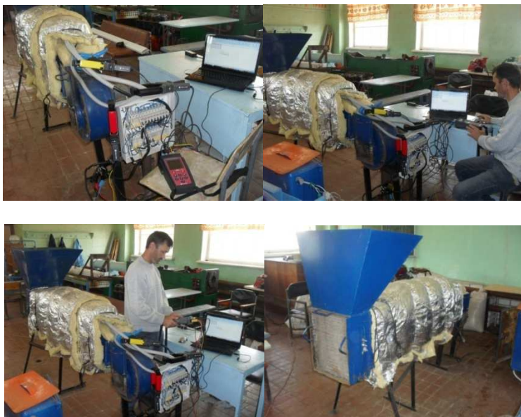
Рисунок 7 – Экспериментальная отработка теплоизоляции
