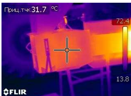
Рисунок 3 – Температурное поле с наружной стороны воздуховода при: мощности 5,6 кВт и скорости движения воздуха 4,4 м/с
