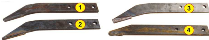
Рис. 4. Рабочие органы (зубья) гребнеобразующих фрез серии GF
