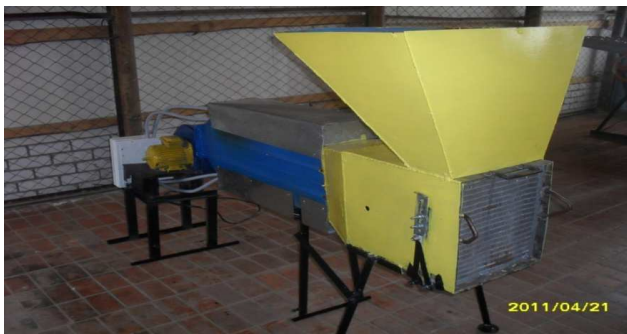
Рисунок 2 – Макет установки для тепловой обработки зерна (вид спереди)
