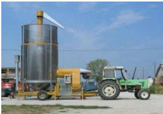
Рисунок 4 – Передвижная зерносушилка MECMAR
