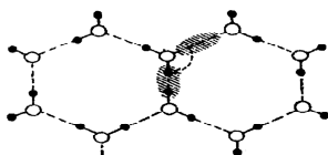
Рисунок 4 – Образование ориентационных дефектов
