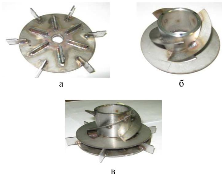
Рисунок 2 – Общий вид основного диска (а), покрывного диска со втулкой и лопастями (б); рабочего колеса (в) устройства ввода и смешивания порошкообразных компонентов с жидкостью
