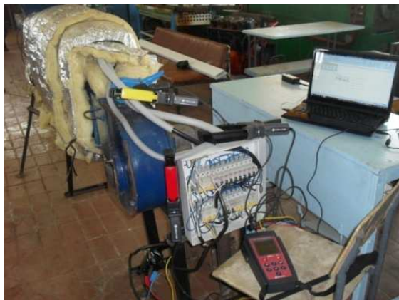
Рисунок 1 – Лабораторные исследования теплоизоляции устройства
