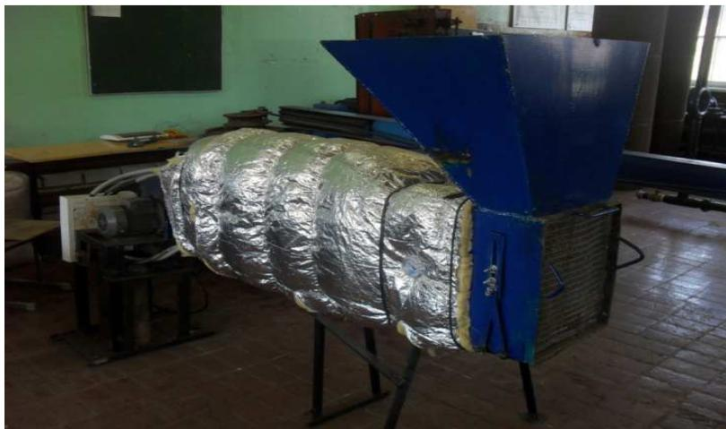
Рисунок 1 – Устройство для исследования процесса сушки зерна
