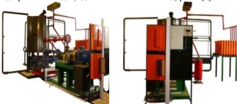
Рисунок 2 – Стенд для сравнительных теплотехнических испытаний электрических подогревателей воды
