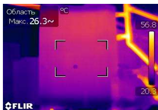
Рисунок 12 – Температурное поле: а, б – отопительной батареи; в – бойлера
