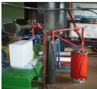
Рисунок 4 – Индукционный (слева) и электродный (справа) подогреватели воды, соответственно SAV-15 и КЭВ-100
