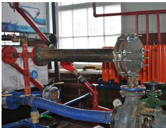
Рисунок 4 – Вихревой теплогенератор (ВТГ)
