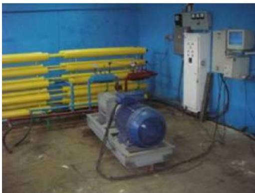
Рисунок 1 – Испытательный стенд для определения работоспособности тепловых гидродинамических насосов ТС1
