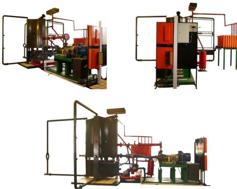
Рисунок 7 – Художественно-конструкторское решение стенда для сравнительных теплотехнических испытаний электрических подогревателей воды
