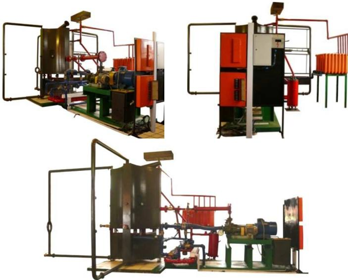
Рисунок 1 – Стенд для тестирования электрических подогревателей воды
