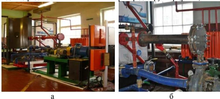
Рисунок 8 – Гидродинамический теплогенератор-деструктор на стенде: а – общий вид стенда; б – фрагмент стенда
