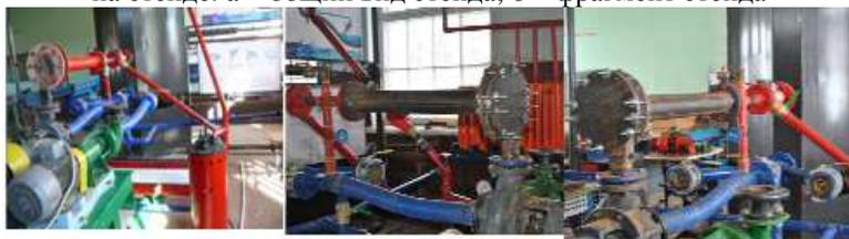
Рисунок 9 – Монтаж гидродинамического теплогенератора-деструктора на стенде
