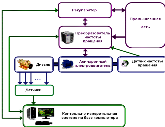
Рисунок 3 – Принципиальная схема функционирования и управления стендом для испытаний дизелей
