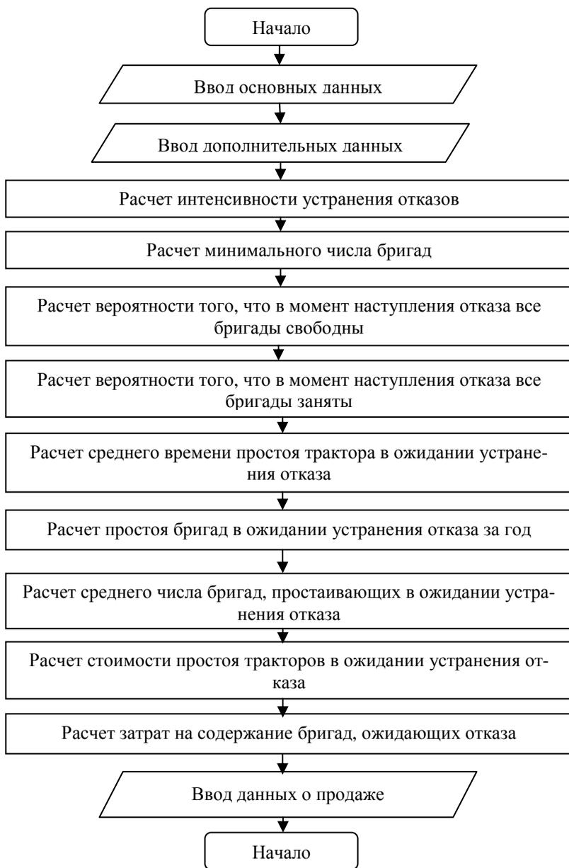
Рисунок 2 – Блок-схема программы для расчета количества выездных бригад
