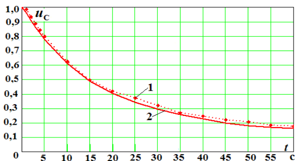
Рисунок 7 – Линейность кривых напряжения саморазряда в относительных единицах, полученных при испытании в третьем режиме: 1 – кривая, полученная при заряде изоляции на 1000 В; 2 – кривая, полученная при заряде изоляции на 2500 В
