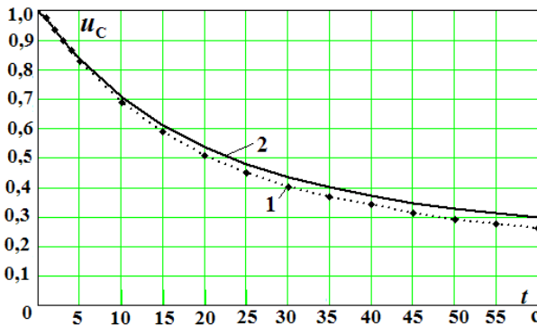
Рисунок 6 – Линейность кривых напряжения саморазряда в относительных единицах, полученных при испытании во втором режиме: 1 – кривая, полученная при заряде изоляции на 1000 В; 2 – кривая, полученная при заряде изоляции на 2500 В
