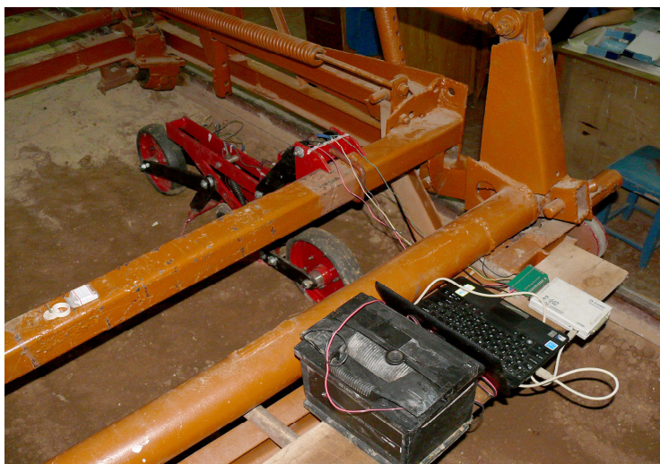
Рисунок 4 – Секция сеялки на раме испытательного стенда
