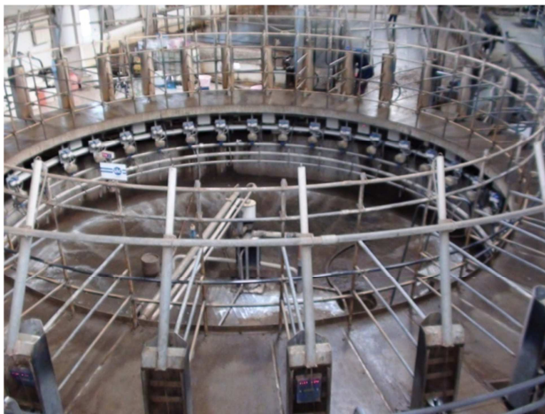
Рисунок 3 – «Карусель» фирмы SAC с 36-ю доильными станками
