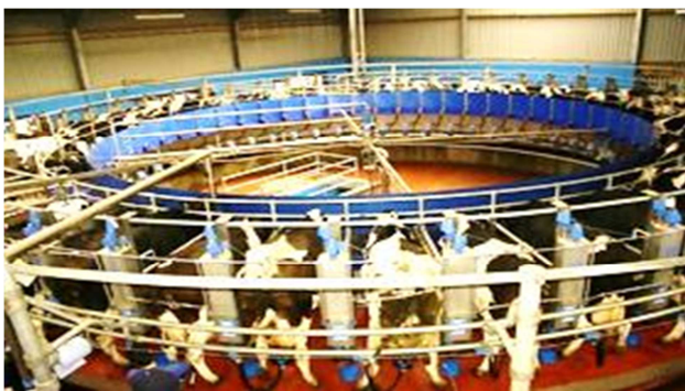
Рисунок 2 – «Карусель» с радиальным расположением доильных станков от фирмы Dairymaster Swiftflo
