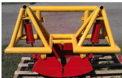
Рисунок 1 – Общий вид агрегата для пересадки мелкокопья «Грыз»
