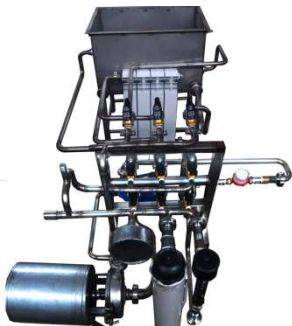
Рисунок 1 – Лабораторный стенд испытаний подогревателей воды (общий вид)
