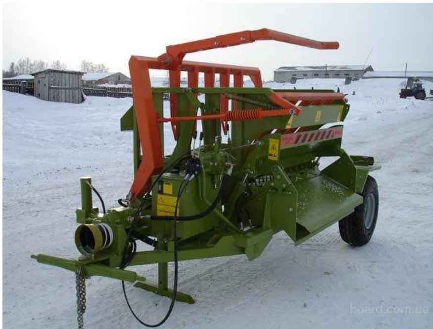
Рисунок 1 – Резчик рулонов – кормораздатчик ИРК-01
