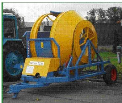
Рисунок 5 – Мобильный измельчитель-раздатчик рулонированных грубых (стебельных) кормов
