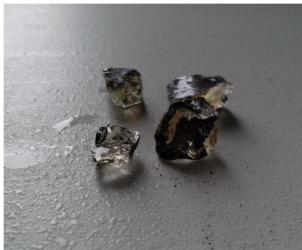
Рисунок 5 – Внешний вид буры при нагреве до 950 °С
