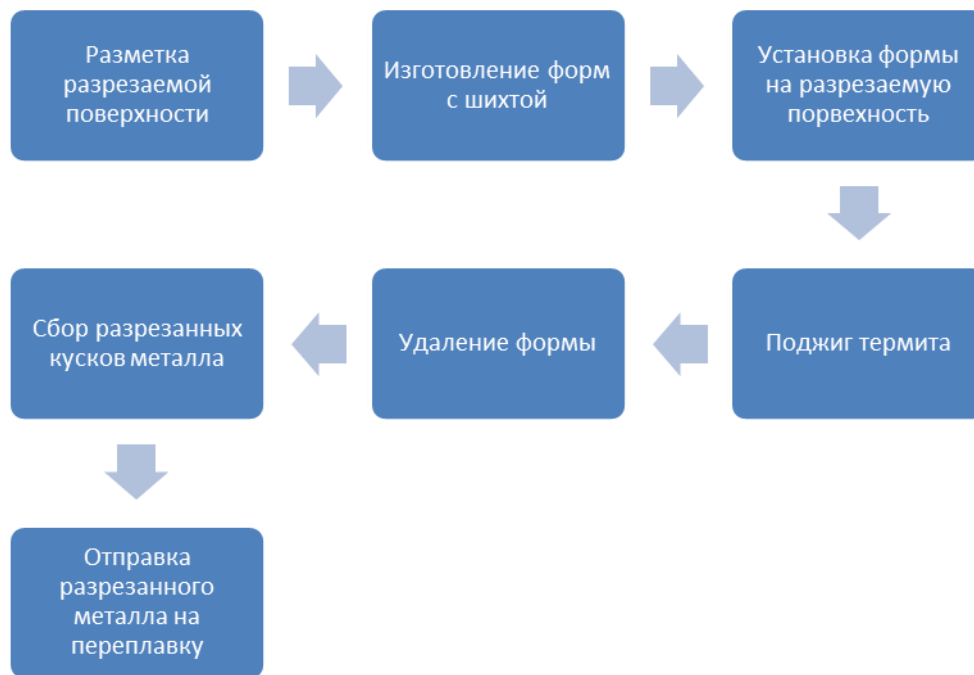
Рисунок 5 – Последовательность операций переработки старого судна
