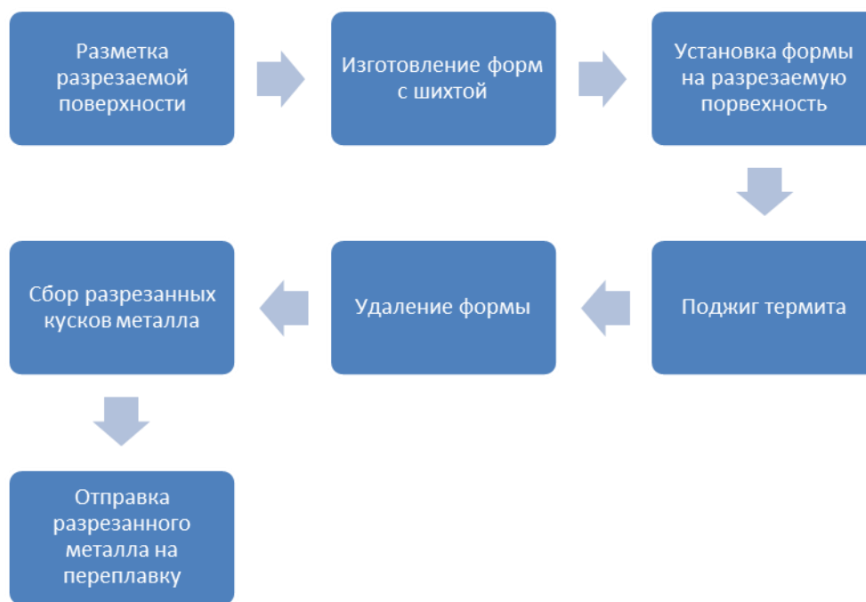
Рисунок 5 – Последовательность операций переработки старого судна
