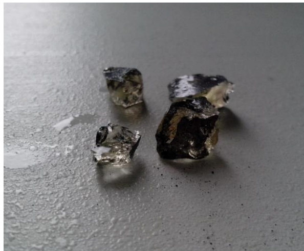
Рисунок 5 – Внешний вид буры при нагреве до 950 °С
