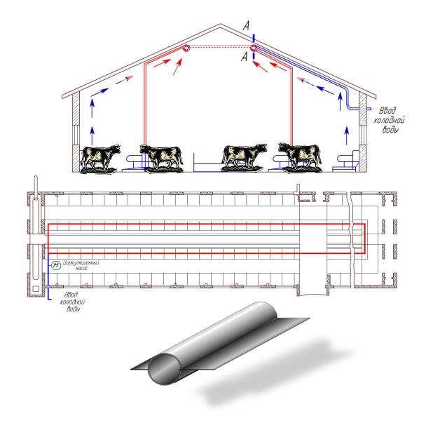
Рисунок 1 – Технологическое размещение устройства теплообменника
