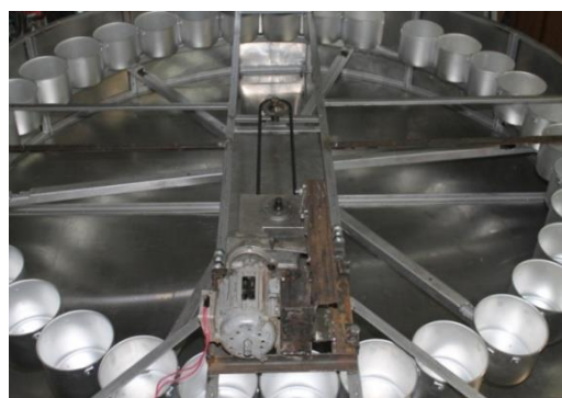
Рисунок 2 – Схема установки для термообработки крови убойных животных:
